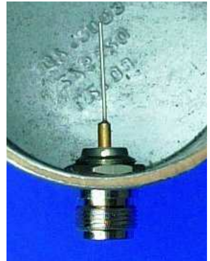
Für 2,4-GHz-WLAN genügt ein 31 mm langer Lambda/4-Strahler aus versilbertem Kupferdraht.
